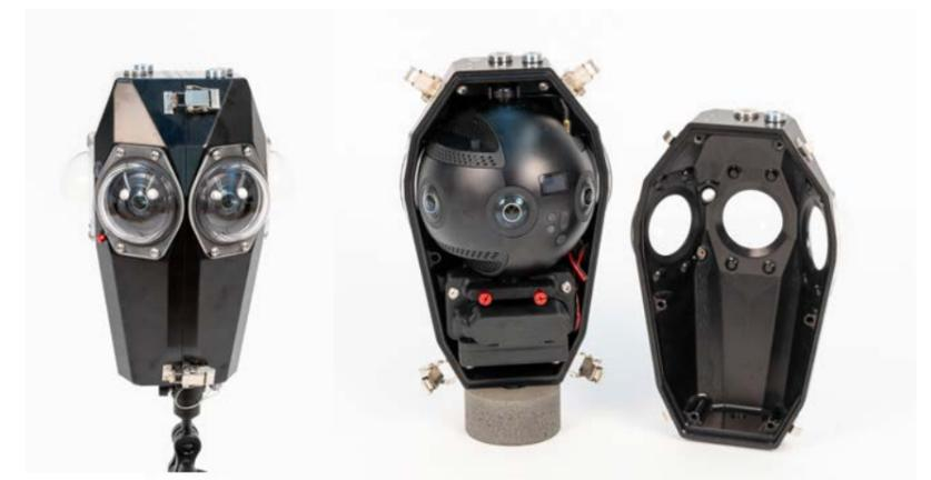
El sistema de cierre utiliza 4 bisagras de acero inoxidable. En el exterior, también hay un botón de encendido mecánico con doble junta o-ring y una pequeña ventana de plexiglás que permite ver la pantalla interna de la cámara. En la parte superior de la carcasa hay 12 orificios roscados M6, 2 orificios cincados que sirven para proteger la carcasa de la corrosión y de las corrientes galvánicas, también hay 2 tapones M14x1, que son predisposiciones para instalar extras opcionales como
