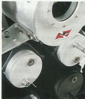
qua, grazie anche a una serie di fori di alleggerimento. Nuovi anche i galleggianti in Delrin, riempiti con materiale incompressibile (45 € l'uno, completo di staffa di alloggiamento a "V"), che rendono neutro l'intero sistema di ripresa video
